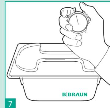
7 Attendre que le temps d'exposition soit entièrement écoulé. (Le temps d'exposition commence, quand le dernier instrument est placé dans le bain).
